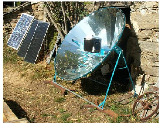
(d) Solar cooker with parabolic reflector
